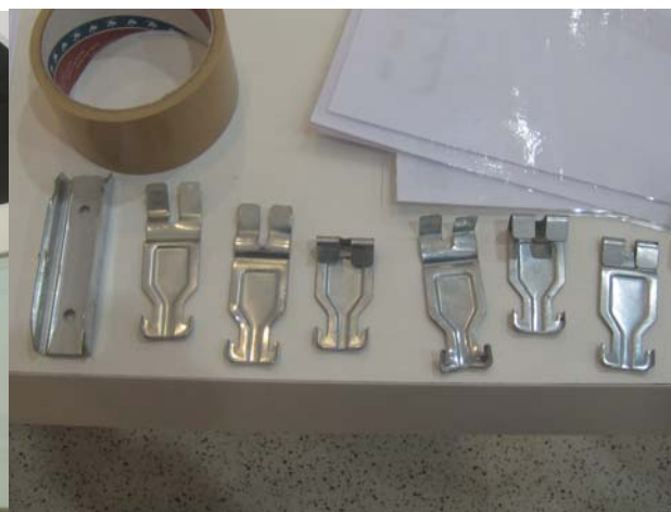
図 22 落下していたクリップ
